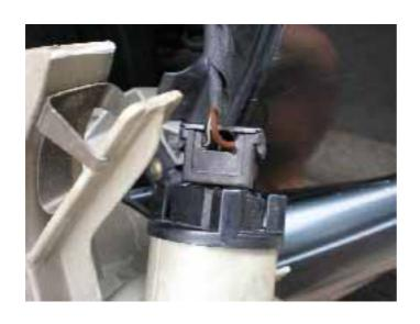
次に、ウインカーからケーブルを外す作業になる。単にソケットから引っ張れば外れるという構造になっていない。観察してみると蓋状のキャップがついている。このキャップの外し方は両サイドのツメを広げ気味にすると外れる。そして蓋を開けた後、ゆっくり引っ張るとケーブルとウインカーが離れる。
