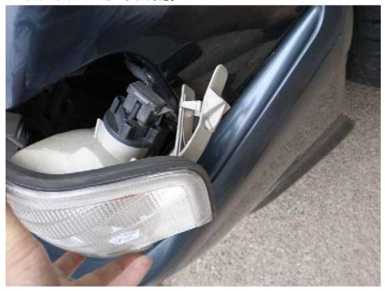
今度は、このウインカーをボディーに押し込むことになるが、単に押しただけでははまらない。単に押しただけの状態の例。ヘッド・ライトとウインカーの間に隙間があることが目視できる。
