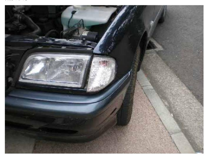
そこでウインカーと同じ目線で注意深く見てみるとウインカー側にオス、ヘッド・ライト側にメスの指し込み口が見える。ここにウインカーのオス状のフックを指し込み、カチンと音がするまで押し込む。カチンという音は、それほど大きな音ではない。
